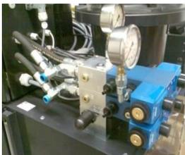
Die Kühlschmierstoff – Steuerung. Verschiedene Druckabgänge und Verschiedene Verteilmengen auf Ihren Revolver
