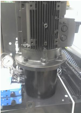
Die Hochdruckeinheit mit Schraubenspindelpumpe. Hier 60l/min mit 65 bar Hochdruck und 11kW Antriebsleistung
