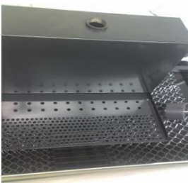
Gleichmäßige Verteilung der Emulsion auf das Filtervliesbett. Dadurch baut sich ein optimaler Filterkuchen auf zur besten Filterung
