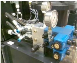
Die Kühlschmierstoff – Steuerung. Verschiedene Druckabgänge und Verschiedene Verteilmengen auf Ihren Revolver
